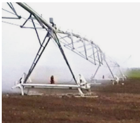
Рис. 1. Дождевальная машина “Кубань” с шагающими двигателями
