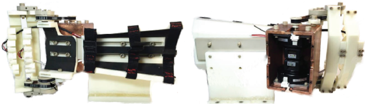
Рис. 17. Экзоскелет кисти, совместимый с магнитно-резонансной томографией
