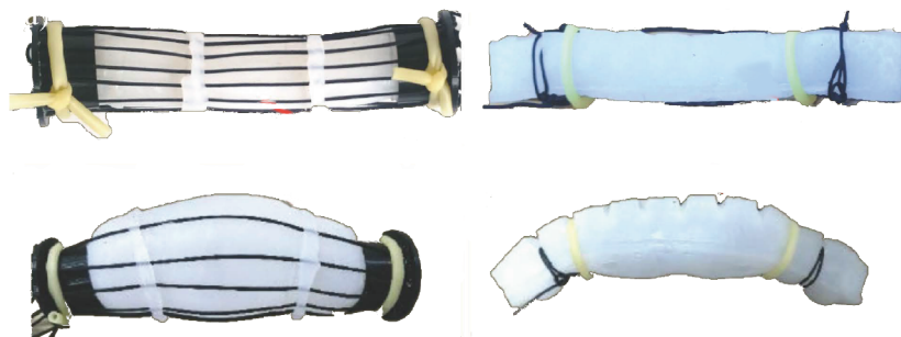
Рис. 10. Анизотропные пневматические мышцы с неравномерным армированием (слева) и с поперечно расположенными канавками (справа)
