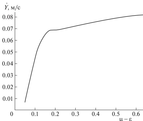
**Рис. 4.** Примеры зависимости средней скорости установившегося движения от разности коэффициентов трения поперек и вдоль конька
