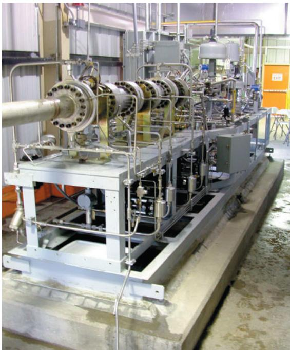
**Рис. 1.** Водородно-кислородный парогенератор мощностью 20 МВт
