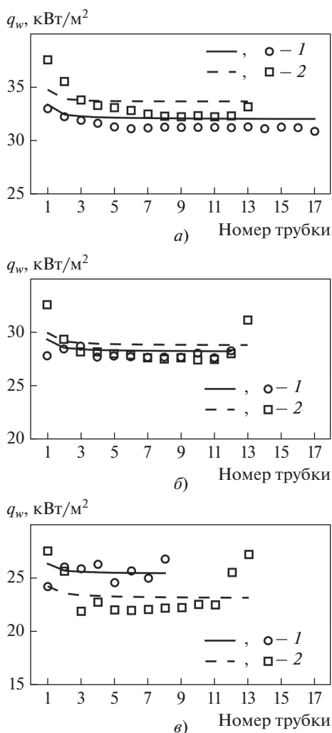
Рис. 7. Распределение плотности теплового потока для труб первого (а), пятого (б) и девятого (в) рядов конденсаторов переменного (1) и постоянного (2) сечения для режима № 5. Объемная доля воздуха на входе в конденсатор r_{a\_in} = 10\% .
