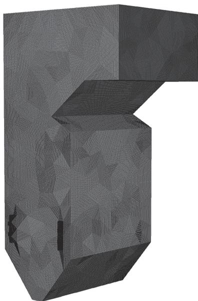
Рис. 2. Расчетная сеточная модель топочной камеры парового котла БКЗ-220-100Ф
