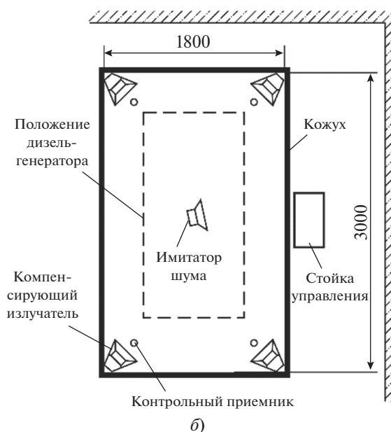
Рис. 8. Внешний вид излучателей системы активного гашения шума (а), схема расположения системы активного гашения и дизель-генератора в лаборатории (б)
