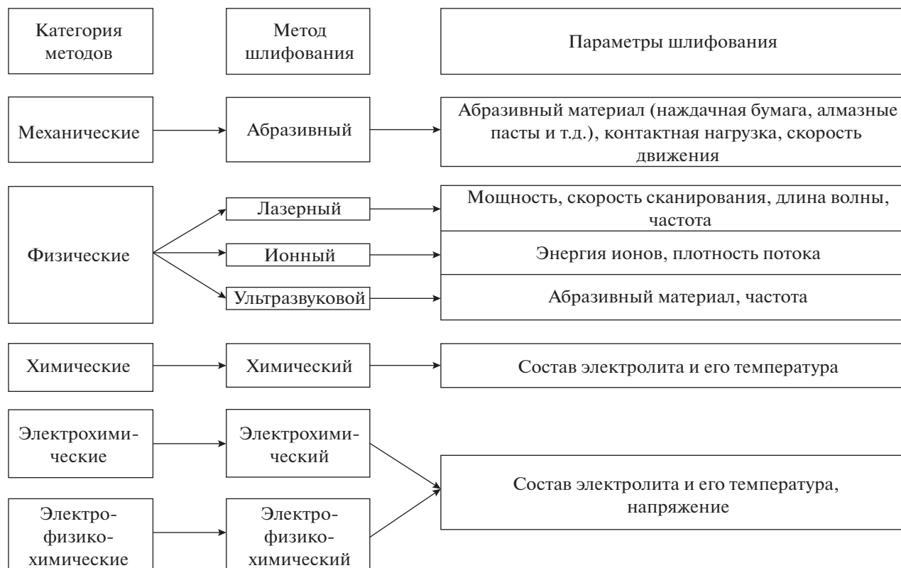
Рис. 4. Классификация методов шлифования поверхности металлов
