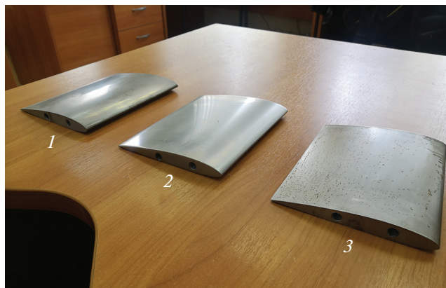
Рис. 3. Образцы профилей NACA2412. 1 – стальной профиль; 2 – профиль с PVD-покрытием; 3 – профиль с ПАВ-покрытием
