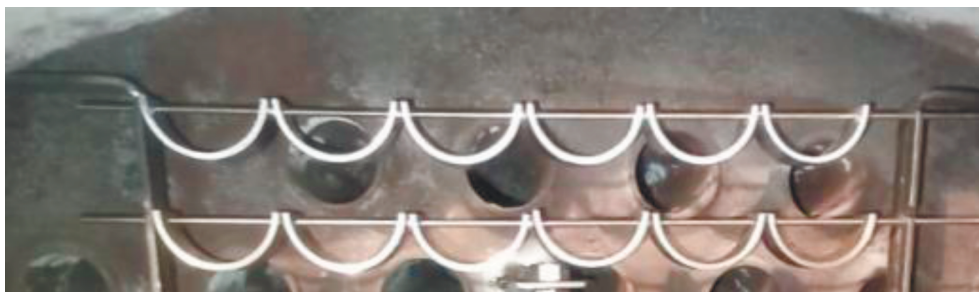
Рис. 4. Размещение образцов в задней дымовой коробке котла
