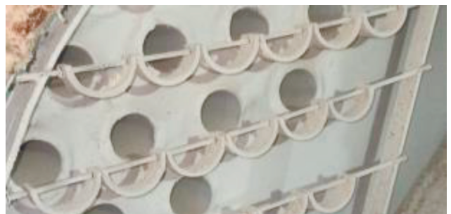
Рис. 7. Образцы после выдержки в течение 1000 ч в топке действующего биотопливного котла
