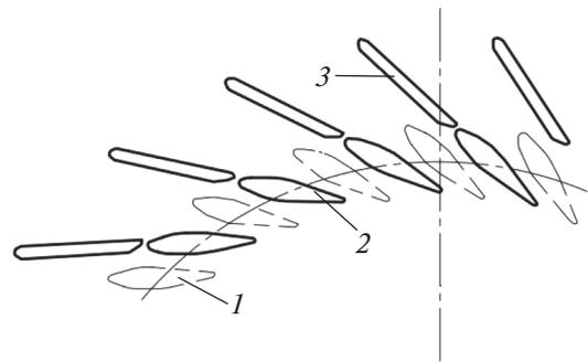
**Рис. 6.** Изменение положения лопаток направляющего аппарата относительно статорных колонн.
