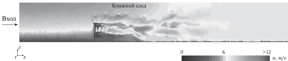
Рис. 7. Вертикальное продольное сечение в центральной плоскости за ветротурбиной с полем скоростей
