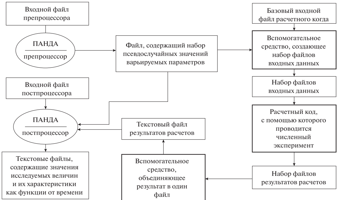
Рис. 2. Общая схема анализа чувствительности и неопределенности
