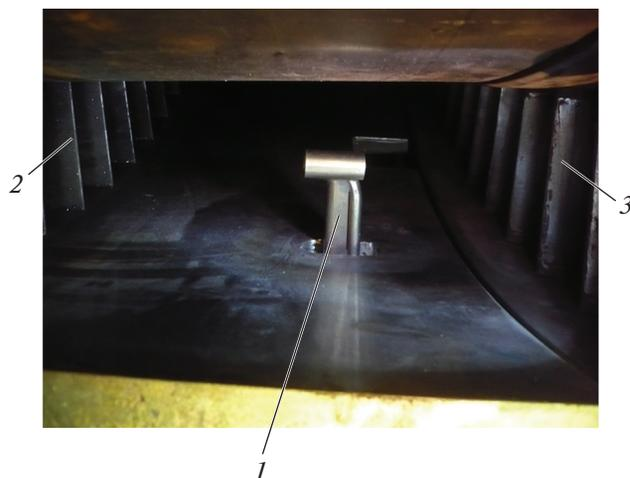
**Рис. 4.** Контрольное сечение ИС 1-0. 1 – комбинированная гребенка; 2 – кольцевая направляющая решетка; 3 – диафрагма первой ступени
