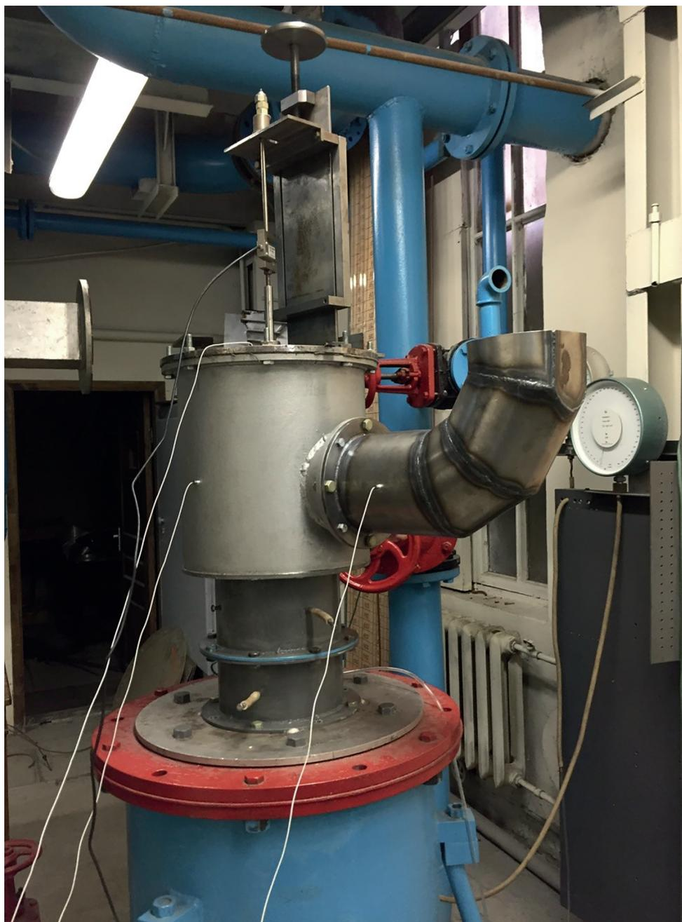
Рис. 1. Внешний вид модели блока клапана с обратным подводом пара
