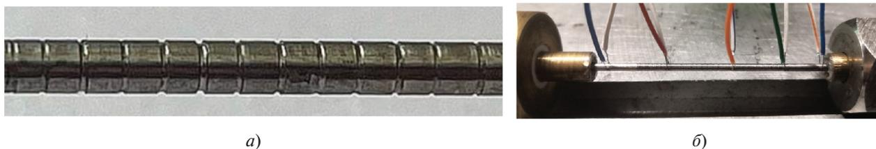
Рис. 4. Внешний вид трубки после накатки (а) и рабочий участок с термопарами (б)
