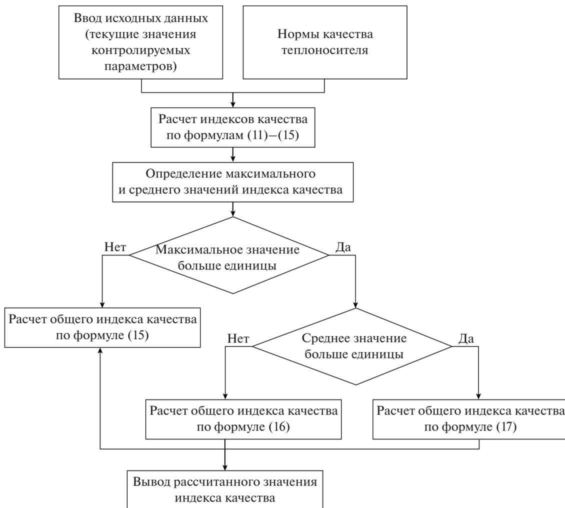
Рис. 4. Блок-схема алгоритма расчета индекса качества
