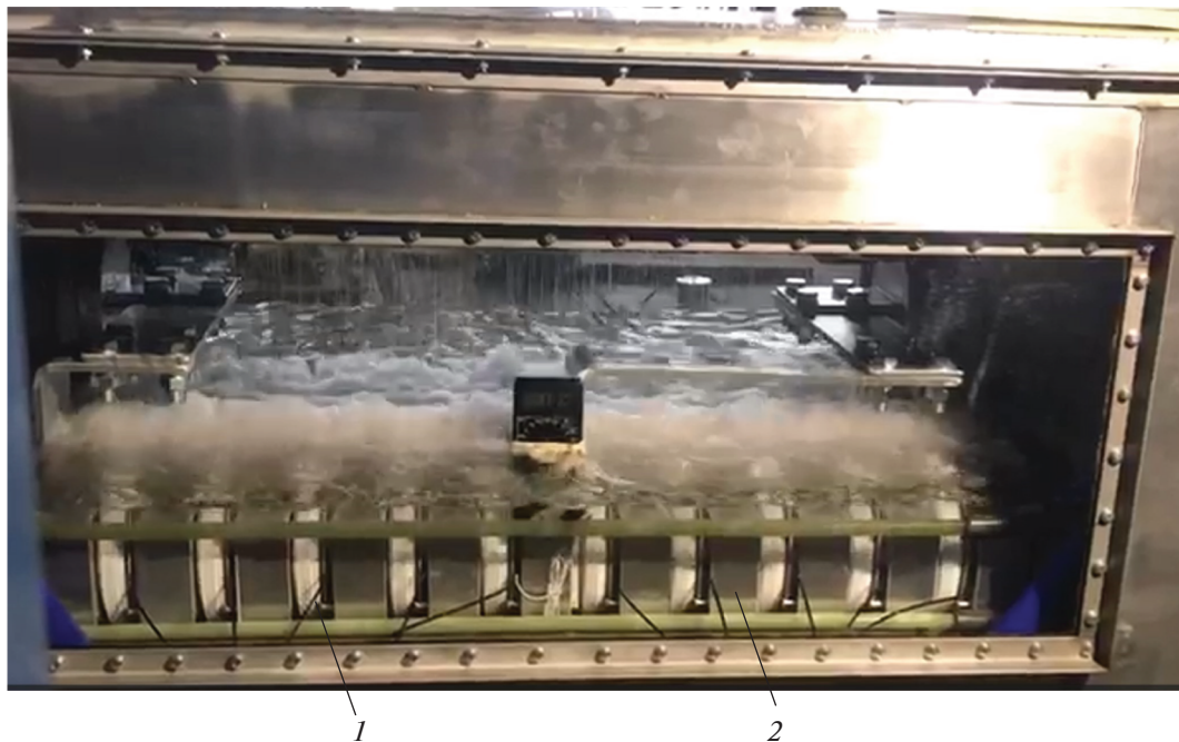
Рис. 12. Фрагмент опытной установки. 1 – тиристор; 2 – радиатор
