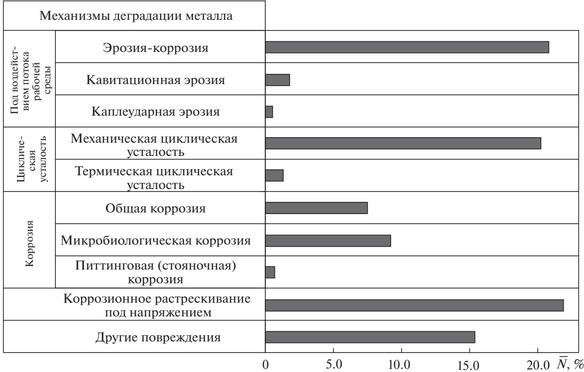
Рис. 4. Статистические сведения из базы данных CODAP о доле повреждений ОиТ \bar{N} энергоблоков АЭС, приходящихся на различные МДМ [8]
