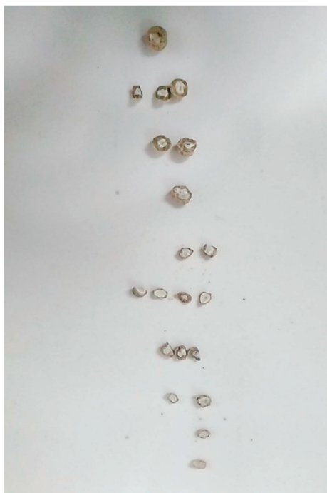
Рис. 3. Вид агломератов золы и инертного материала в разрезе
