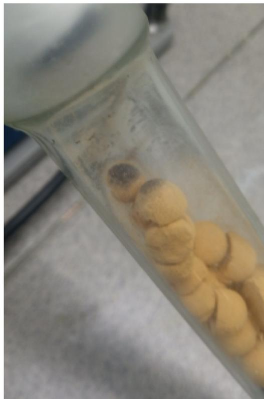
Рис. 3. Внешний вид адсорбента на основе шлама после взаимодействия с сернистыми соединениями
