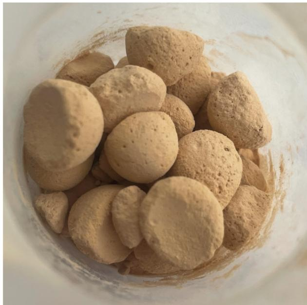
Рис. 2. Внешний вид адсорбента на основе шлама водоподготовки
