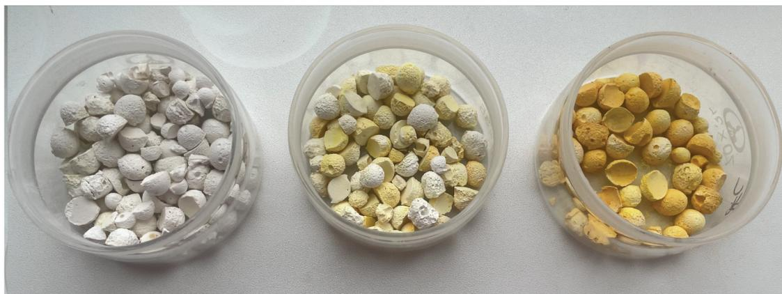
Рис. 5. Изменение окраски сорбента-индикатора при контакте с сернистыми соединениями
