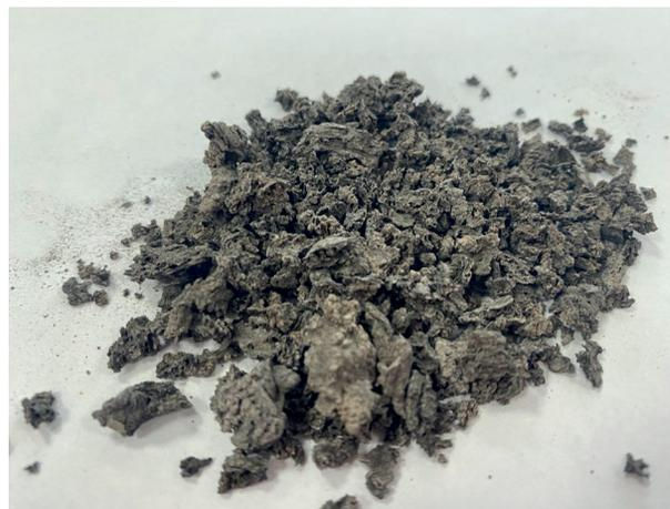
Рис. 3. Фотоснимок частиц прокаленной бентонитовой глины
