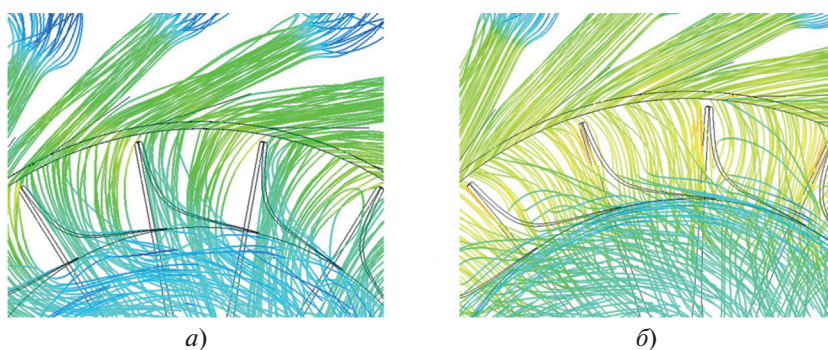
Рис. 7. Структура потока sCO_2 ( a ) и продуктов сгорания природного газа ( б ) вблизи входных кромок рабочих лопаток
