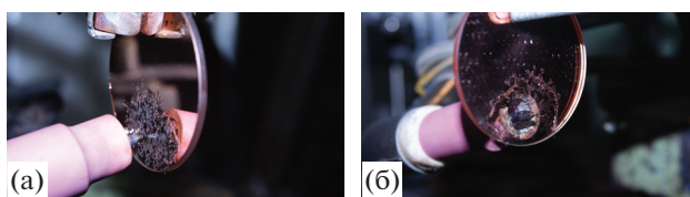
Рис. 2. Внешний вид пластинок с покрытием после горения сварочной дуги: рабочая зона съемки с лицевой (а) и обратной (б) сторон пластины.
