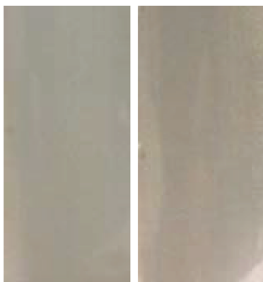
Рис. 3. Изображения столба жидкости с примесью мела до (слева) и после обработки микропузырьками (справа).
