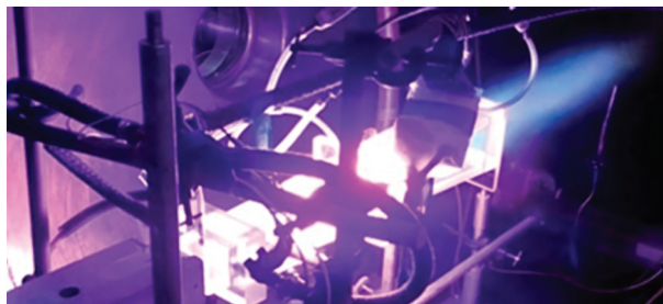
Рис. 1. Фотография плазменно-стимулированного горения пропан-воздушной смеси в расширяющемся аэродинамическом канале длиной 50 см.
