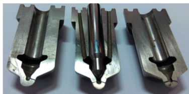
Рис. 1. Традиционные многодырчатые распылители поршневых двигателей внутреннего сгорания в разрезе.
