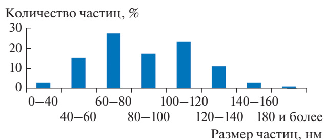
Рис. 3. Распределение по размерам при P = 20 МПа, T_{\text{нас}} = 40^\circ\text{C} , T_{\text{у.р.}} = 40^\circ\text{C} .
