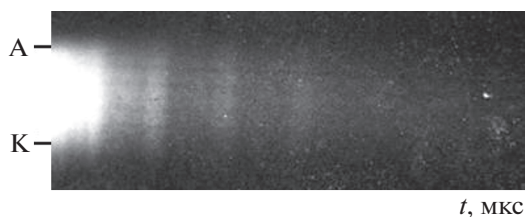
Рис. 4. Развертка свечения плазмы в искровом разряде.
