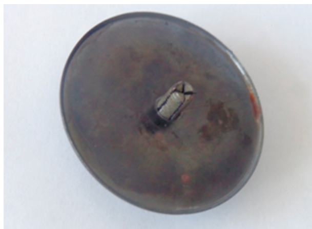
Рис. 3. Крышка газовой горелки для бытовых плит с интенсификатором теплоотдачи в виде резьбы и щелевыми зазорами в стержне.
