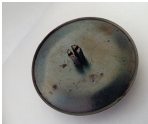
Рис. 4. Крышка газовой горелки для бытовых плит с интенсификатором теплоотдачи в виде стержня с резьбой и расширяющимися щелевыми зазорами.
