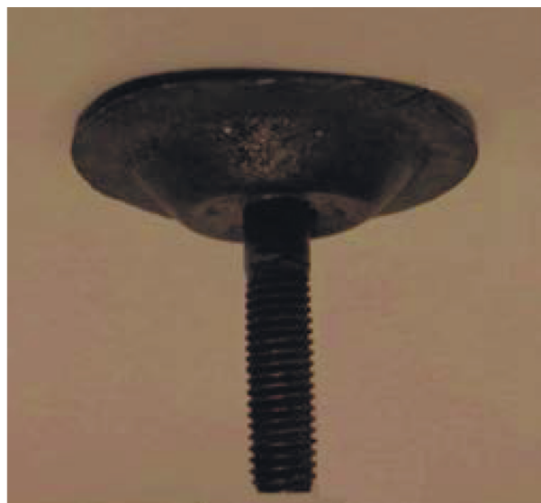
Рис. 2. Крышка газовой горелки для бытовых плит с интенсификатором теплоотдачи в виде резьбы.
