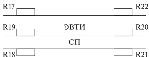
Рис. 1. Размещение аналоговых датчиков температуры на экранно-вакуумной тепловой изоляции и сотовой панели “Б1”: R17, R22 – АДТ снаружи ЭВТИ; R19, R20 – АДТ под ЭВТИ; R18, R21 – АДТ под СП.
