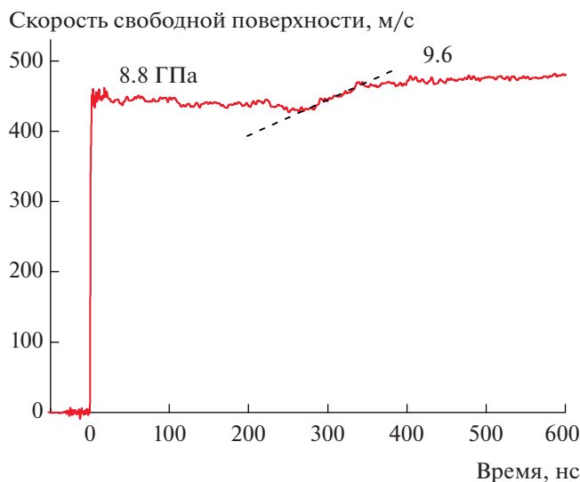
Рис. 9. Профиль скорости контактной поверхности образца расплавленной эвтектической смеси Bi–Pb и окном из монокристалла LiF при 212°C [74].
