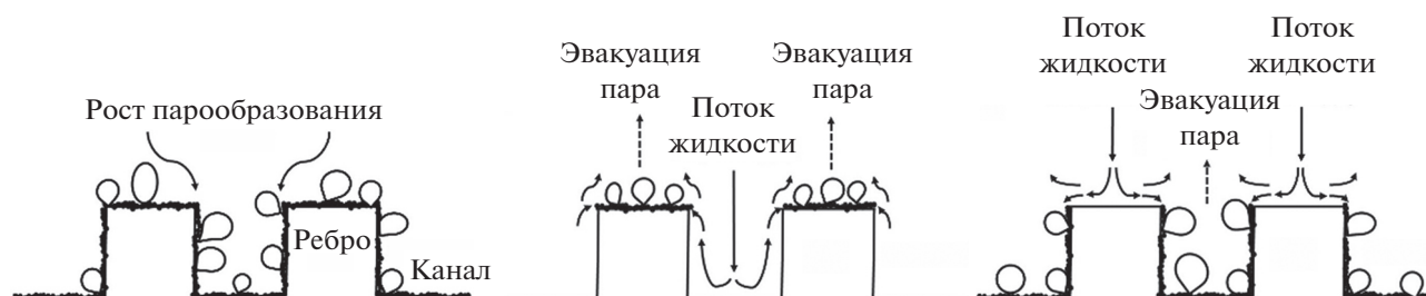
Рис. 20. Механизмы двухфазного теплообмена на различных типах комбинационных микро/наноструктурированных покрытий [3].
