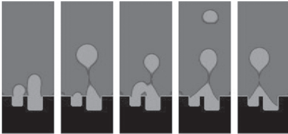
Рис. 16. Взаимодействие пузырьков, образующихся при высоких тепловых потоках на полостях разного размера [121].
