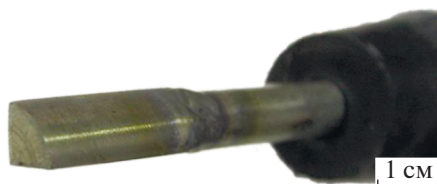
Рис. 2. Вид образца стали, подготовленного для погружения в расплав теплоносителя.
