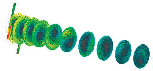
Рис. 15. Векторы скорости в поперечных сечениях вихревой трубы.
