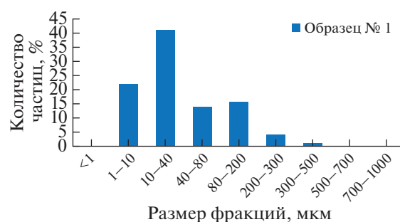
Рис. 3. Распределение частиц образца № 1 по размерам; средний размер частиц d = 51.72 мкм.
