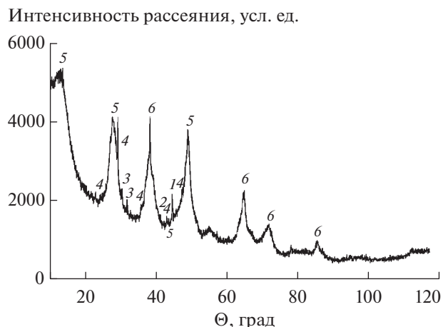
Рис. 3. Рентгеновский спектр продуктов окисления гидрогенерирующей композиции: 1 – Al, 2 – Bi, 3 – Sn, 4 – CaCO 3 , 5 – α-Al 2 O 3 , 6 – AlOOH.
