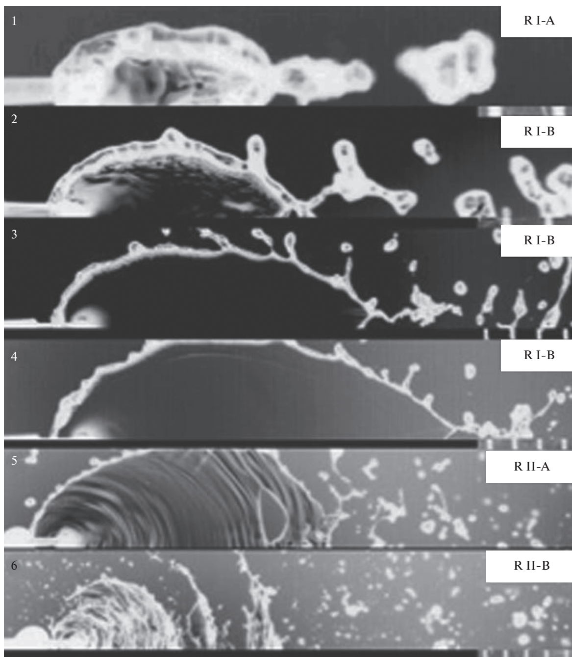
Рис. 6. Распад жидкостной пелены при угле между струями 2\theta = 90^\circ (из работы [42]). R I-A: фото 1: U = 2.06 м/с; R I-B: фото 2: U = 2.67 м/с; фото 3: U = 3.98 м/с; фото 4: U = 5.13 м/с; R II-A: фото 5: U = 5.5 м/с; R II-B: фото 6: U = 7.64 м/с.
