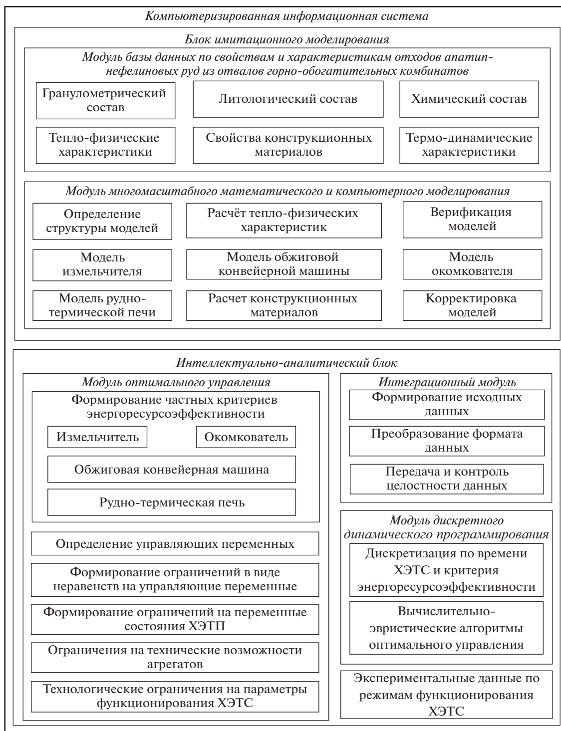
Рис. 2. Схема архитектуры информационной компьютеризированной системы поддержки принятия решений по оптимальному управлению энергоресурсоэффективностью ХЭТС переработки отходов апатит-нефелиновых руд.
