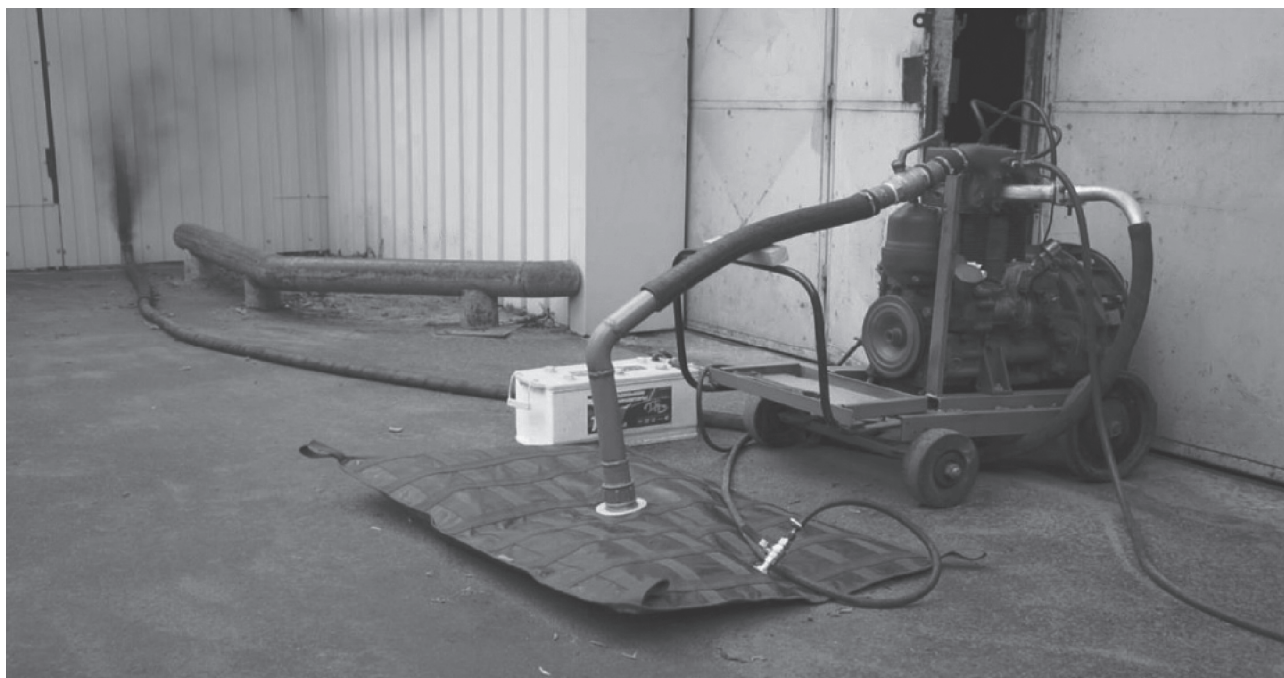
Рис. 1. Внешний вид установки для исследования ДВС на ацетилене.
