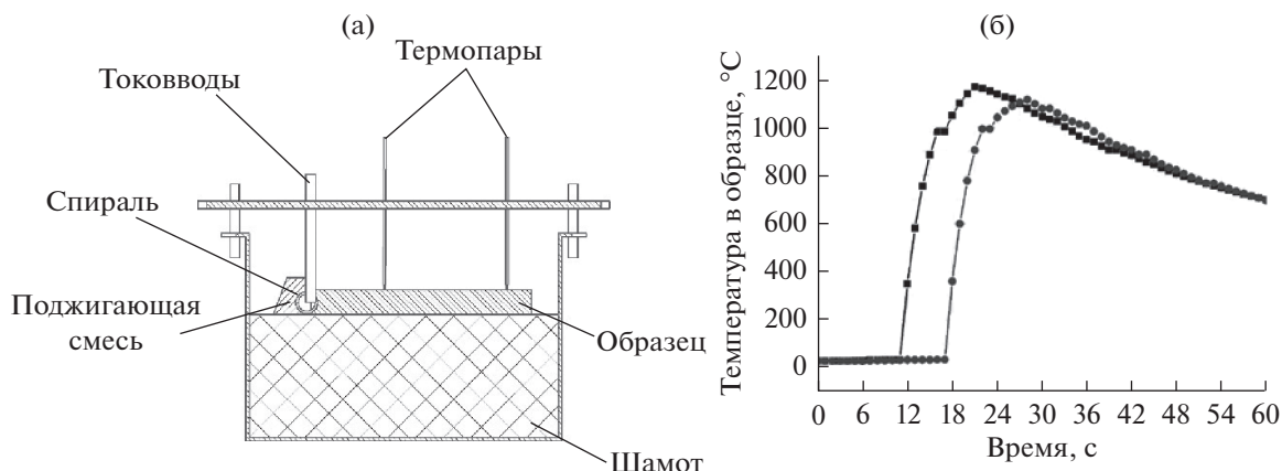
Рис. 3. Схема устройства для измерения скорости горения (а) и примеры термограмм (б).
