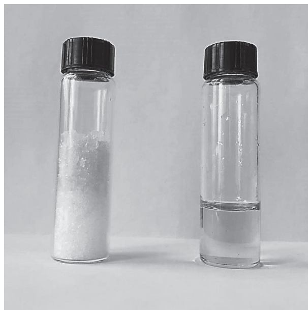
Рис. 1. Этапы синтеза глубокого эвтектического растворителя на основе хлорида холина и сульфосалициловой кислоты: слева – смесь двух твердых компонентов; справа – жидкая гомогенная смесь.
