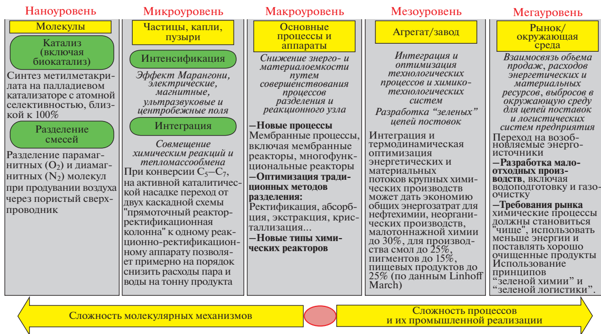
Рис. 3. Классификация способов энергоресурсосбережения на различных иерархических уровнях промышленного предприятия.
