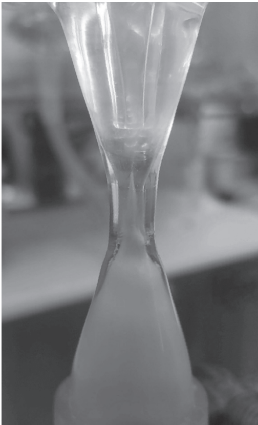
Рис. 9. Подсос воздуха в горловине в микро-ВСА-1 при подключении Т + Т в незатопленном аппарате при расходе 6 л/мин.
