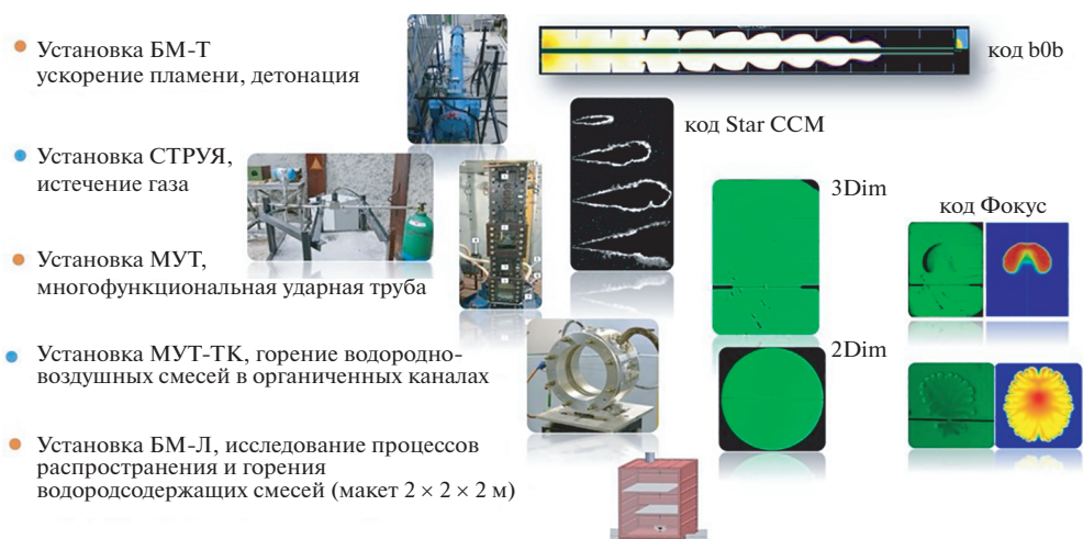
Рис. 7. Установки, созданные во Всероссийском НИИ технической физики им. академика Е.А. Забабахина, для исследований по водородной безопасности
