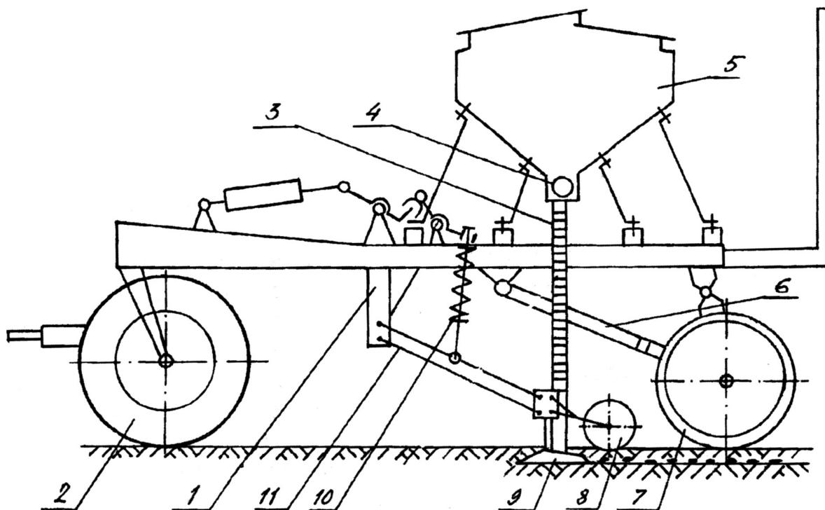
Схема экспериментальной сеялки: 1 – рама; 2 – самоустанавливающееся пневматическое колесо; 3 – семяпровод; 4 – высевающий аппарат; 5 – бункер для семян и удобрений; 6 – шарнирная тяга; 7 – прикатывающие катки; 8 – каток сошника; 9 – лаповый сошник; 10 – нажимная пружина; 11 – поводок сошника в виде параллелограммного механизма.
