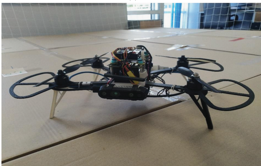
Рис. 2. Пример отдельных разработок лаборатории испытательной “робототехники” Военного инновационного технополиса “ЭРА” РТК – беспилотных летательных аппаратов. БпЛА “Шоршик” (а) разработан для проведения исследований в области автономной навигации, оборудован специализированными датчиками для сбора пространственной информации в реальном времени, что позволяет строить карту исследуемого пространства и осуществлять навигацию; БпЛА “Первый” (б) разработан для проведения исследований в области автономной навигации и отработки алгоритмов, его основное преимущество относительно аналогов – ремонтпригодность.
