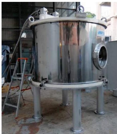
Рис. 7. Высокоградиентный магнитный сепаратор для удаления накипи из питательной воды ТЭЦ (Япония).
