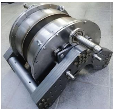
Рис. 3. Криостат в сборе со сверхпроводниковой магнитной системой и магнитопроводом.
