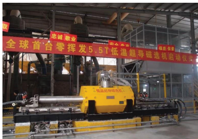
Рис. 5. Испытания высокоградиентного сверхпроводникового магнитного сепаратора (г. Цюаньчжоу, КНР).
