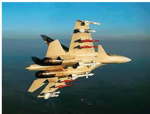
Рис. 2. Размещение и номенклатура авиационных средств поражения на внешних узлах подвески современного самолета.
