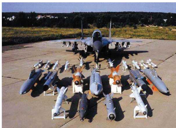
Рис. 2. Размещение и номенклатура авиационных средств поражения на внешних узлах подвески современного самолета.
