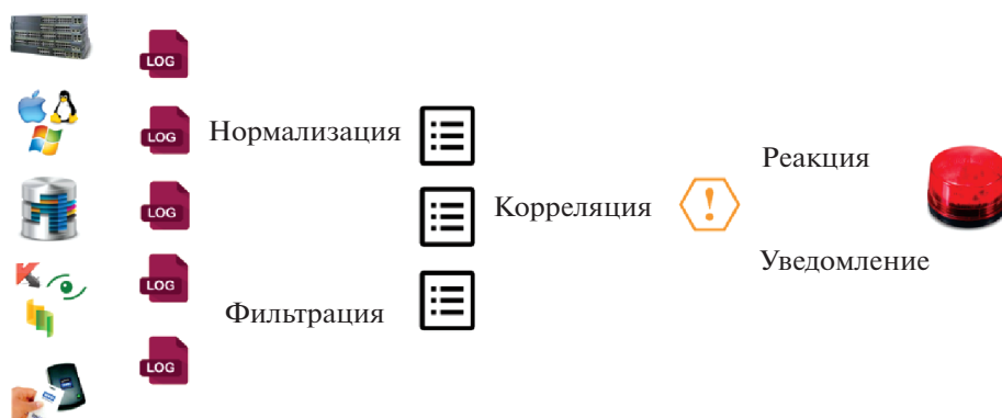
Рис. 2. Принцип работы SIEM-системы.
